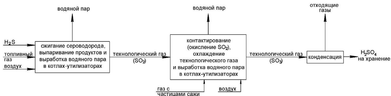
Рисунок 8.4 – Блок-схема производства серной кислоты по методу мокрого катализа
