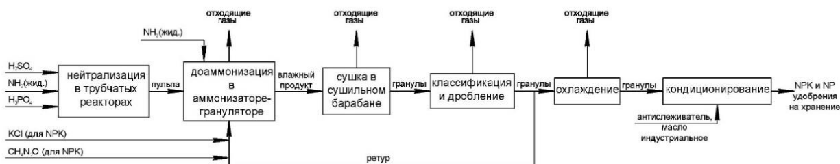
Рисунок 13.1 – Блок-схема производства NP- и NPK-удобрений по схеме «трубчатый реактор – аммонизатор-гранулятор – сушильный барабан»
