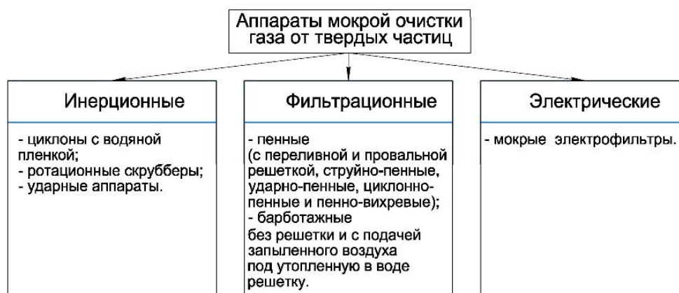
Рисунок 5.2 – Классификация аппаратов мокрой очистки газа от твердых частиц
