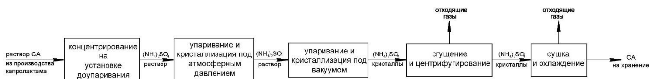
Рисунок 11.1 – Блок-схема производства СА из сульфатных щелоков
