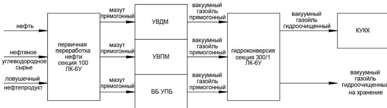
Рисунок 22.2 – Блок-схема процесса переработки нефти с получением гидроочищенного вакуумного газойля
